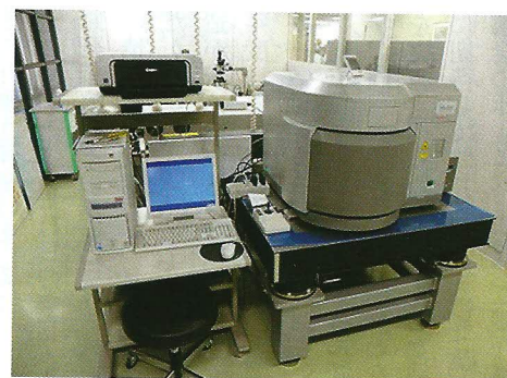
レーザーラマン分光装置 (物質をピークによって解析する装置)
