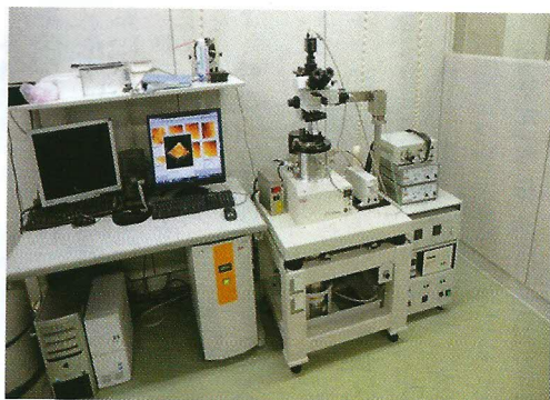
SPM走査型プローブ顕微鏡 (微小な領域まで見える特殊な顕微鏡)
